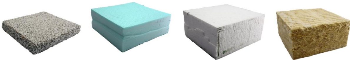
2. sz. kép: A vizsgált minták a zsugorosteszt elvégzése után: Styron, XPS, EPS, FKD.
