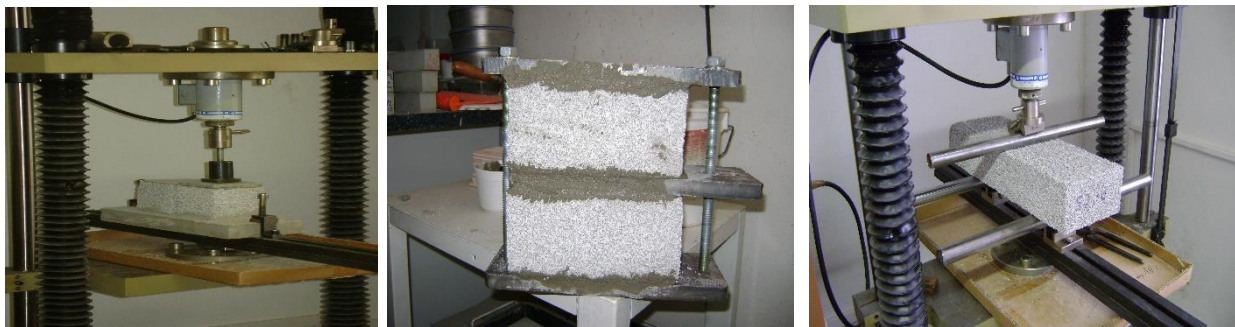
1. sz. kép: Nyomószilárdság, csúszó és hajlítószilárdság mérése kelet-német TIRAtest 2200 gépen
