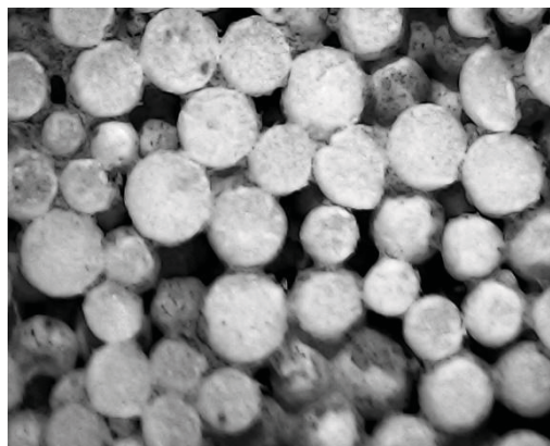
6. ábra: STYRCON: UMO 19 optikai mikroszkópban 7x-es nagyítás Forrás: saját szerkesztés (2020)
