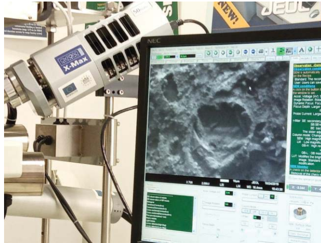
16. ábra: JEOL X-MAX elektronmikroszkóp Forrás: saját szerkesztés (2020)
