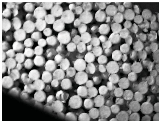
10. ábra: STYRCON metszet: UMO 19 optikai mikroszkópban 3x-os nagyítás Forrás: saját szerkesztés (2020)
